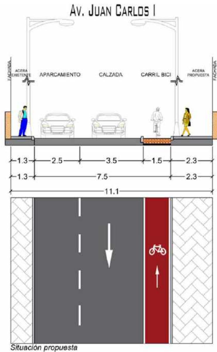
Figura 80. Comparativa de la situación actual y la situación propuesta para la implementación del carril bici.
